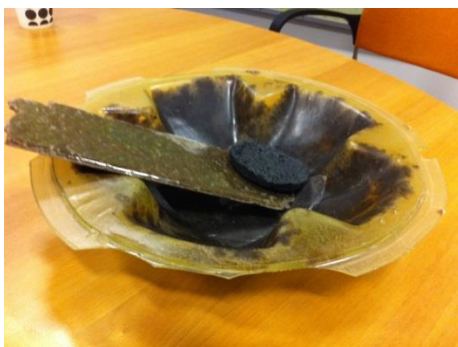
ASFALT UIT ZEEFGOED (LINKS VAN STANDAARD CELULOSE EN RECHTS VAN ZEEFGOED-CELLULOSE ) EN COMPOSITIEN VAN ZEEFGOED-CELLULOSE (RECHTER FOTO)
